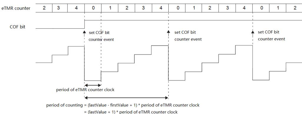
2、method 配置成 eTMR\_COUNTER\_INCREASE\_DECREASE, 计数器值到达 lastValue 值时会产生 COF 中断。即首先计数器会从 firstValue 逐个递增计数到 lastValue 值, 计数器发生 COF 中断, 然后向下计数到 firstValue 值, 又向上计数到 lastValue 值, 计数器又发生 COF 中断, 如此反复;
