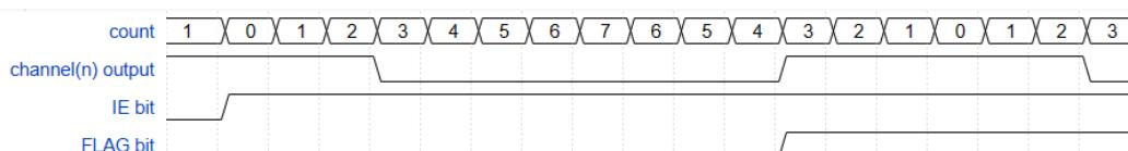
6. 镜像模式死区插入: 死区插入的时钟是输入时钟经过死区分频后的时钟。死区分频只能分 1, 4, 16 三个频率。比如, SDK 中默认配置 system clock 的频率是 48MHz, 死区分频为 4, 那么死区插入的时钟频率 12MHz, 假设死区插入的 value 值是 12, 那么死区的时间是 1us。
