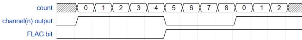
2. 中心对齐：计数器从 FIRST 寄存器值开始递增计数，计到 LAST 寄存器后，递减计数到 FIRST 寄存器值，然后又开始递增计数，如此反复重复。电平变化是在计数器达到 CH\_CNT 寄存器的值时发生。CH\_SCR[FLAG] 标志位在每个周期中第二次计数器达到 CH\_CNT 寄存器值时置位，同时通道产生中断。
